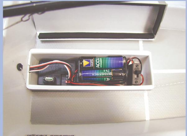
Con una lima tonda, praticare una apertura di circa mm. 10 sul contenitore batterie/ricevente (dalla parte del lato più alto), inserire il contenitore al suo posto e sistemare la ricevente e la batteria come indicato in figura. Ricordarsi che l'antenna della ricevente dovrà essere sistemata in modo che sia completamente stesa. (Si consiglia fuori, lungo l'albero)
