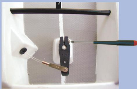
Tenere dritto il timone, posizionare la lava di comando come mostrato in figura e stringere con la vite autofilettante da mm 2,9 x 9,5. Avvitare la forcella di metallo sul bowden del comando e collegarla alla leva come mostrato in figura.
