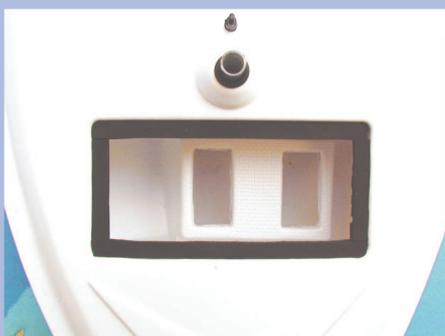
Incollare la guarnizione adesiva di gomma lungo il bordo del vano servocomandi.
