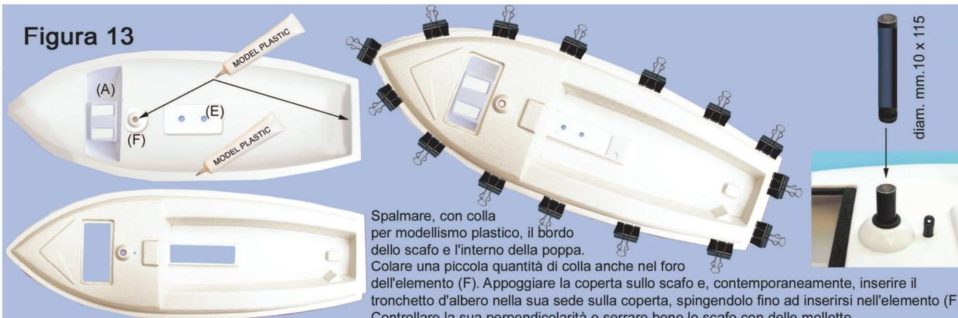
Spalmare, con colla per modellismo plastico, il bordo dello scafo e l'interno della poppa. Colare una piccola quantità di colla anche nel foro dell'elemento (F). Appoggiare la coperta sullo scafo e, contemporaneamente, inserire il tronchetto d'albero nella sua sede sulla coperta, spingendolo fino ad inserirsi nell'elemento (F). Controllare la sua perpendicolarità e serrare bene lo scafo con delle mollette.
