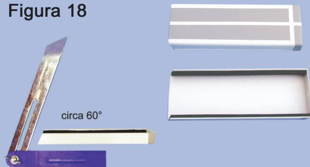
Dopo aver tagliato uno dei lati più corti del coperchio (B), in modo che si accosti perfettamente alla parte interna della coperta, incollare la guarnizione adesiva di gomma lungo il suo bordo interno.
