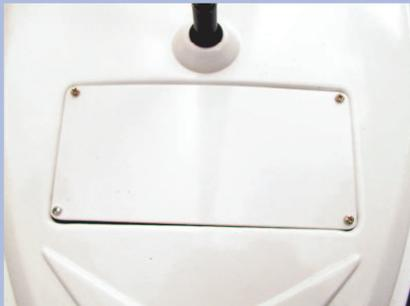
Prendere la tavoletta di plastica (G), (vedi fig. 8), arrotondare un po' gli angoli e, se necessario, aggiustatela sull'apertura del vano servi. Bloccarla con quattro viti autofilettanti da mm. 2,2 x 9,5.
